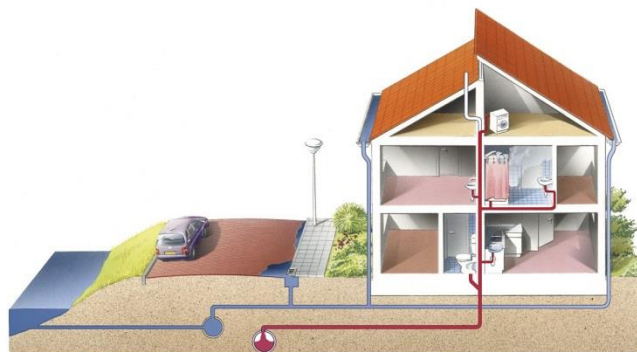
afbeelding 11: Gescheiden riolering. Bron: Paul Maas, Tilburg/Stichting RIONED
