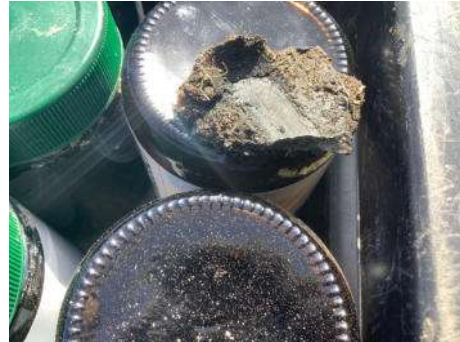
220155.2, meetpunt 112, laag 100-200, bijz. asbestverdacht 257521401
