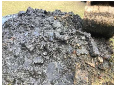
220155.2, meetpunt 114, laag 150-300, bijz. puin 257521402
